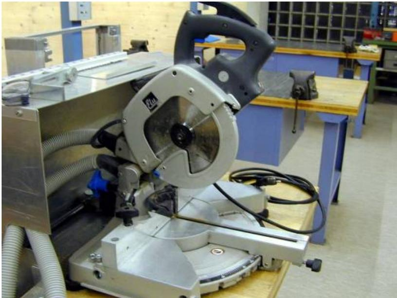
Die Maschine ist regelmässig zu reinigen und alle beweglichen Teile sind zu ölen.
