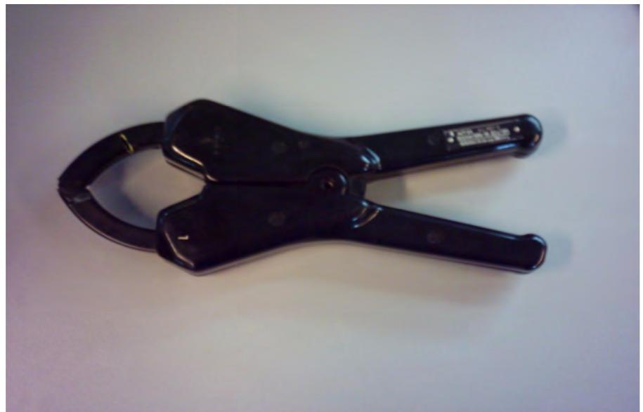
La pince ampère métrique est un ampèremètre dont l'enroulement secondaire du transformateur d'intensité est incorporé dans la pince. L'enroulement primaire est représenté par le conducteur traversant la pince. Le courant
