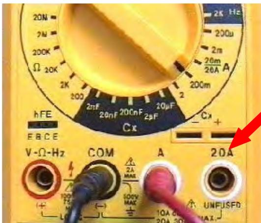
L'appareil sera branché comme sur le schéma ci-dessus. Toujours bien réfléchir à la valeur de la mesure. Par prudence, utiliser le shunt interne (20A). Dans le cas de cet appareil mettre le sélecteur sur la bonne gamme de mesure.
