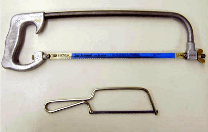
Scie à métaux. Tendre la lame avant utilisation. Monter la lame avec les dents dirigées vers l'avant.
