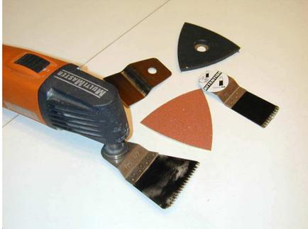
La **scie vibrante** est une machine très pratique pour les ouvertures et les découpes dans les matières synthétiques. Elle présente également l'avantage d'être sans danger pour les doigts ( pour les lames non tranchantes !).
