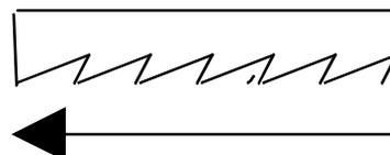
Lors d'un changement de lame, il faut diriger les dents du côté du sens de la poussée !
