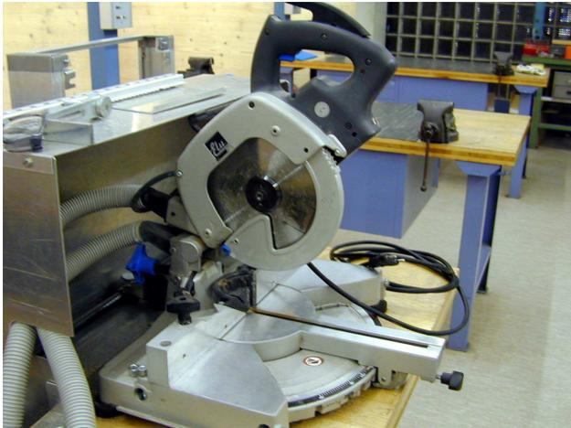
Cette machine est utilisée pour couper des canaux d'installation ou d'allège, des couvercles en PVC.
