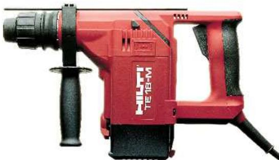
Le principe de la **frappe pneumatique** consiste à comprimer de l'air par un piston entraîné par le moteur. Cet air va ensuite pousser violemment un piston qui va entraîner un percuteur. C'est ce percuteur qui va déplacer le burin et créer la frappe.
