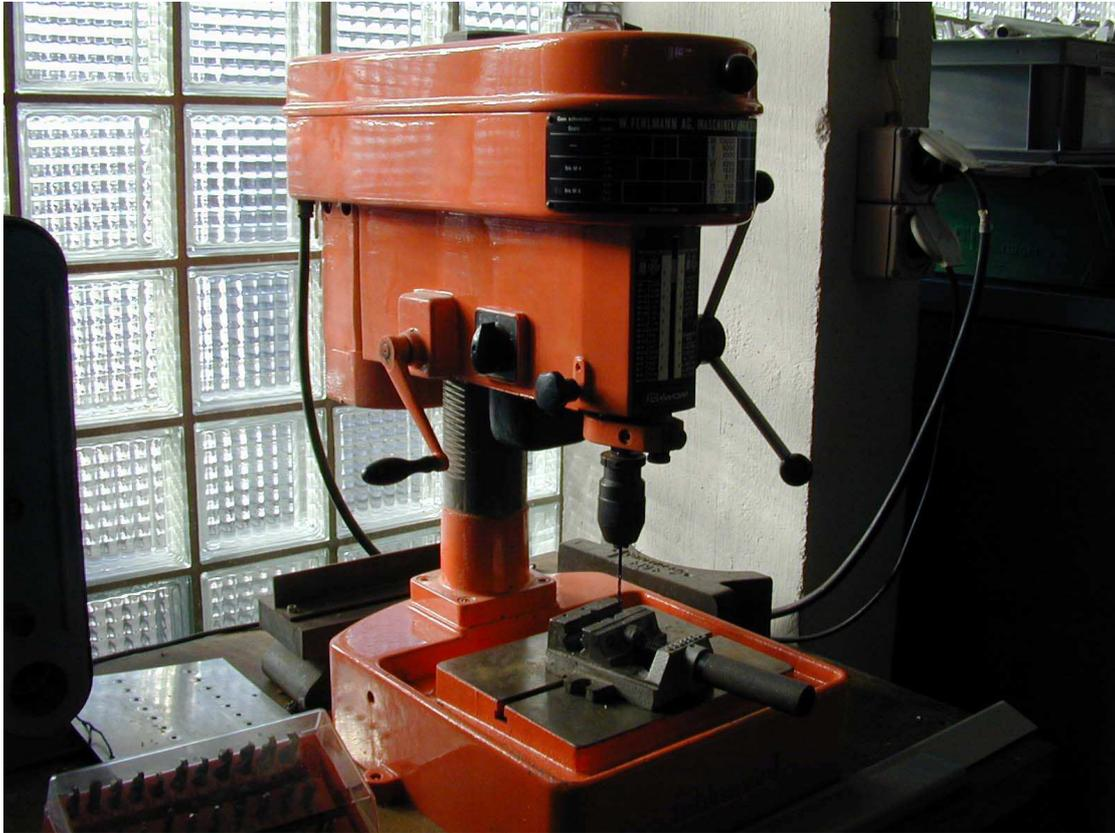
La perceuse à colonne est une machine très pratique qui sert à réaliser des trous dans du métal, du plastique, du bois, etc ... en offrant plus de précision qu'une perceuse portable.
