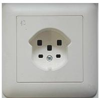
La prise type 25 se distingue de la T15 par des contacts carrés dans la partie 230 V. La type 25 supporte 16 A et le raccordement se fait à l'aide de vis. On peut la raccorder en 5 x 2.5 mm<sup>2</sup>.
